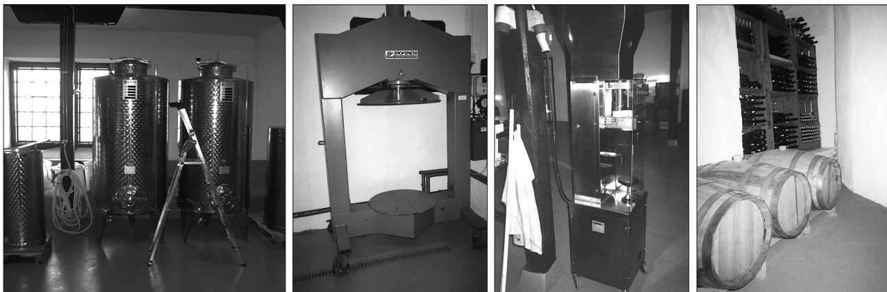
FIGUR 2. Jäsningstankar, vinpress, buteljeringsmaskin och ekfat – exempel på specialutrustning som behövs för vinberedning.
