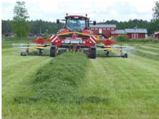
Bild 32. Med en bred stränläggare ökar kapaciteten för balning eller inkörning i silo. (foto: Lars Ericson).
