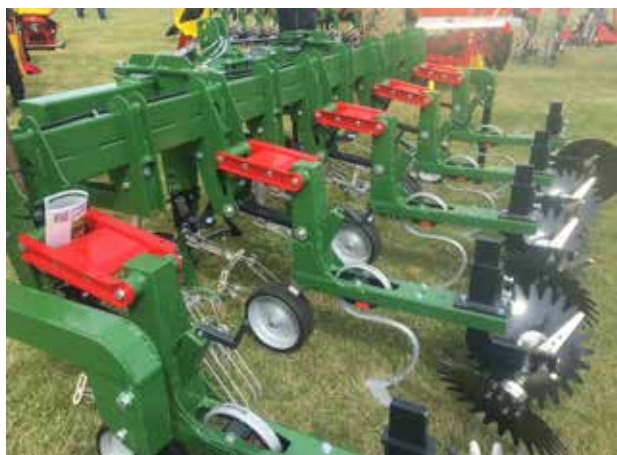
Bild 44. Effektivt redskap för mekanisk ogräsbekämpning i potatis. (foto: Åsa Rölin)
