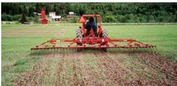
Bild 17. Ogräsharvning med långfingerharv. (foto: Maria Norgren)
