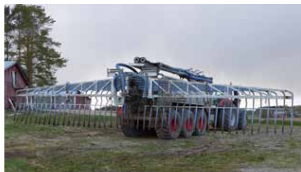
Bild 5. Stora spridare är en risk. Bra att fördela vikten på fler hjul, för att minska hjullasten. (foto: Lars Ericson)
