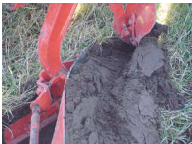
Bild 16. Med föroplog får man en bra anslutning mellan tiltorna. (foto: Ingvar Persson)
