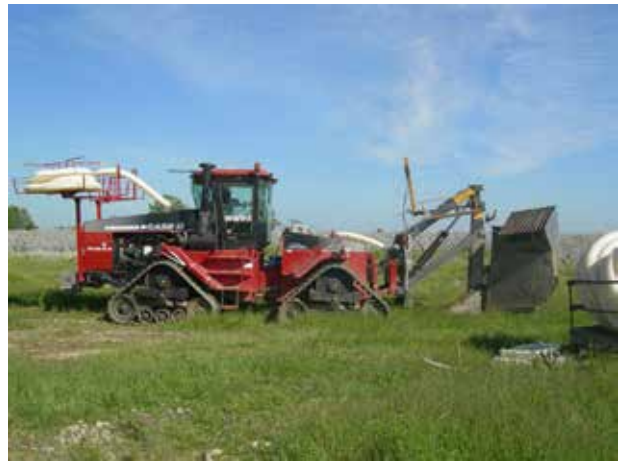
Bild 3. Täckdikningsmaskin med plog för grävfri läggning. Grusficka möjliggör installation av filter på röret. (foto: Torsten Lindberg)
