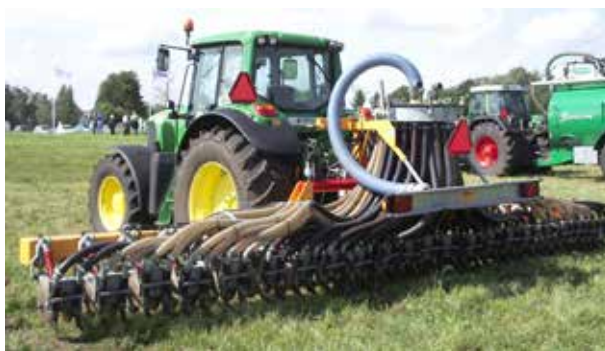
Bild x. Utrustning för myllning av flytgödsel och spridning med matarslang minskar kväveförlusterna och markpackningen. (foto: Lars Ericson)
