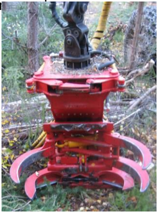
Naarva-Grip 1500-40E. Fällhuvud med klipp. Aggregatet saknar matarhjul men har en stabil ackumulering.
