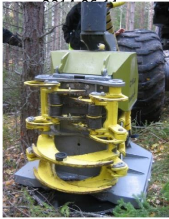
Bracke C16. Fällhuvud med sågklinga. Aggregatet saknar matarhjul men har en relativt stabil ackumulering
