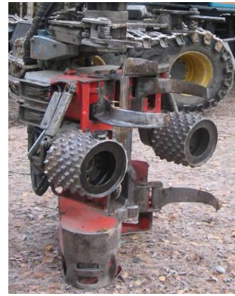
Log Max 4000 B skördaraggregat med sågsvärd och matarvalsar. Aggregatet har en tillförlitlig ackumulering.
