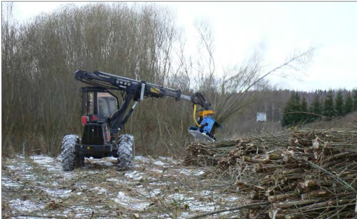
Figur 10.1 Klippaggregat, här skörd av äldre Salix-bestånd. (Foto J-O Helldin)
