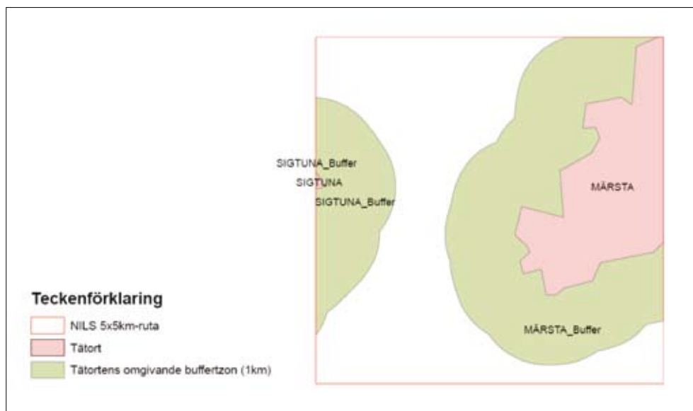
Figur 6. Ett exempel på hur polygoner för tätorter med 200 eller fler invånare i landet har valts ut av Sveriges 1 940 tätorter. Tätorter har sedan fått en buffert på 1 000 meter. Tätorts- och buffertzons-polygonerna har sedan slagits ihop med bibehållna gränser, och dessa har slutligen klippts ut med NILS 5 x 5-kilometerslandskapsrutor.
