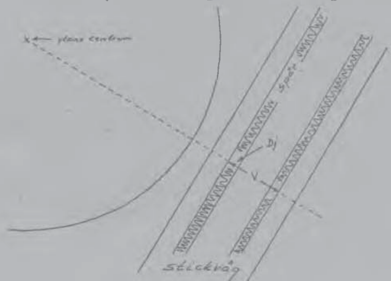
Figur 2. Snitt för mätning av spårningsvidd (V) och spår djup (Dj).
