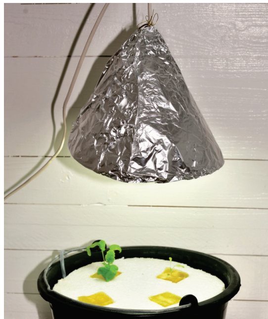
Hemmabyggt lampskärm av ståltråd och aluminiumfolie. Kom ihåg att lämna en öppning i toppen så att sladden med lamphållaren kan träs igenom.
