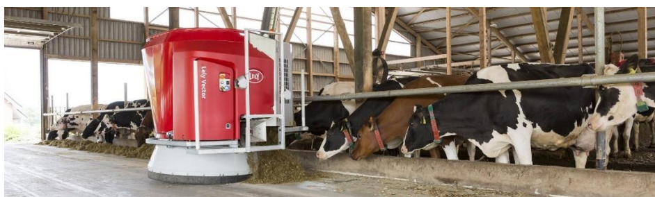
Figur 3. Exempel på eldrivet och självgående utfodringssystem (Lely Vector).
