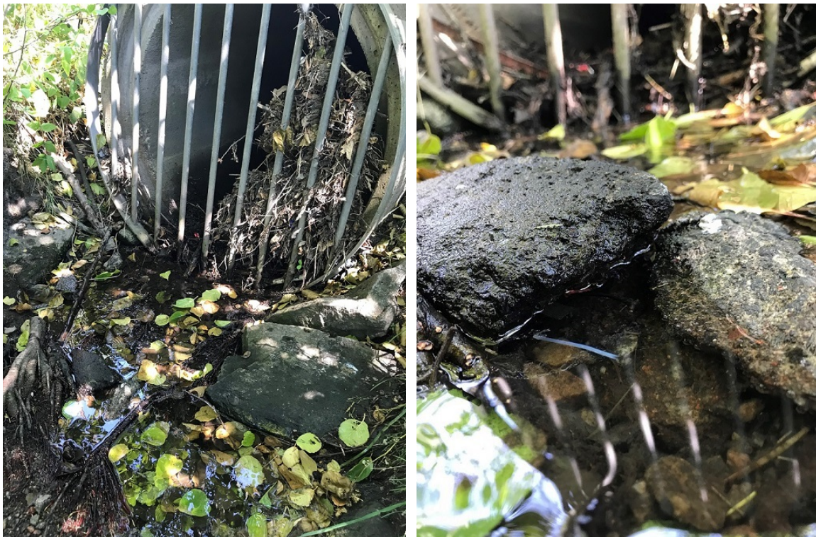
Figur 6. Exempel på montering av provtagare i rörmyrning (punkt Li2). Till vänster om rörmyrningen ligger TIMFIE-provtagarens spruta gömd under stenar och kvistar, flödesrestriktorn leds ut i vattenflödet och göms/förankras under diverse småstenar. Insugslangen mynnar nere till vänster i bild, fäst under den mindre, svarta stenen som även visas i närbild i det högra fotot. I den högra bilden kan man se den vita insugslangen som ligger fritt i vattenflödet, SPE-kolonnen ligger under stenen. I vänstra bilden: observera kvistar och blad som fastnat högt upp i gallret i rörmyrningen, vilket indikerar hur högt flödet är vid kraftigt regn.
