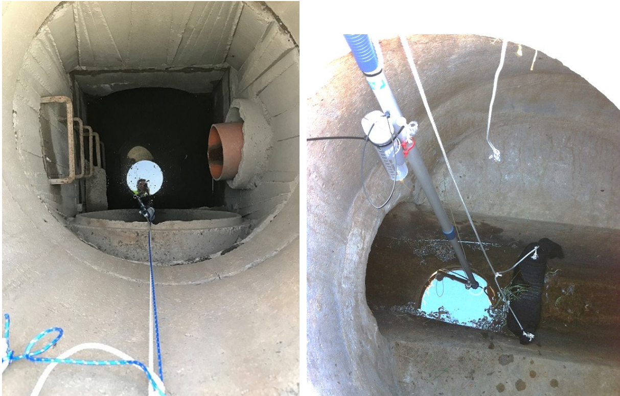
Figur 4. Till vänster visas ett exempel på montering av provtagare i dagvattenbrunn där det alltid står gott om vatten (punkt U2) och till höger en lokal där basflödet är mycket lågt varför ett dämme monterats (punkt Å1).
