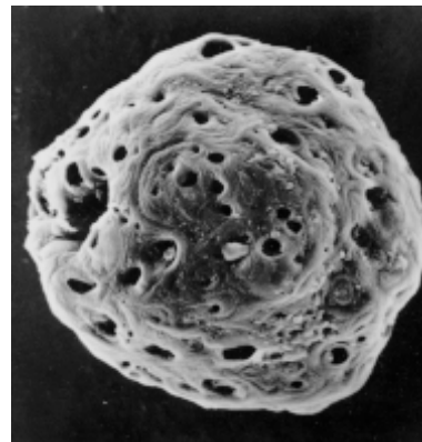
Figur 4. Svepelektronmikroskopbild av en flygaskpartikel. Dessa består av ett ihåligt kolskelett och är oftast mellan 5 och 30 µm stora.
