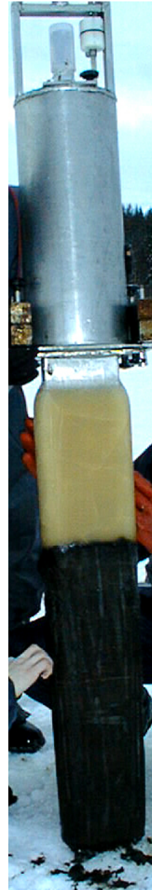
Figur 1. Provtagning av det översta sedimentlagret (ca 60 cm) i Källsjön gjordes med frysprovtagare.
