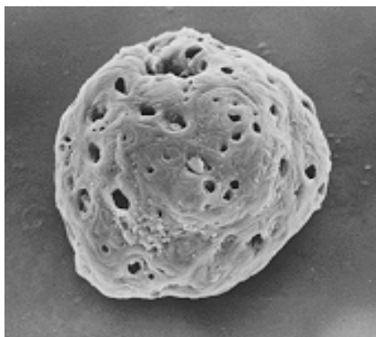
Figur 2. Foto av flygaskpartikel taget i svepelektronmikroskop. Denna typ av partikel från fossil förbränning är normalt 5 – 30 \mu\text{m} i diameter.
