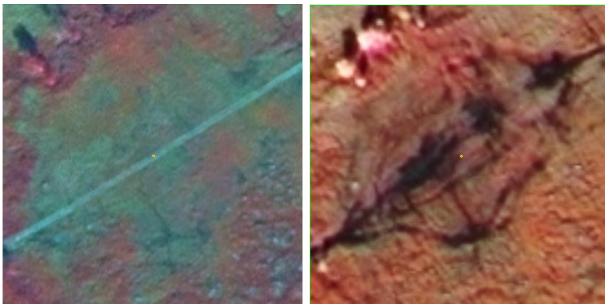
Figur 24. Bilden till vänster visar exempel från 2018, på en förstärkning över ett blött parti. Vår bedömning är att här verkar körspåren ha börjat växa igen. I den högra bilden, från 2008, syns ett antal tydliga körspår. En viss inverkan bör den fuktiga terrängen i bilderna från 2008 ha på synligheten, men om man jämför med figur 23 (från samma område) så syns oftast de äldre spåren ändå, fast svagare.
