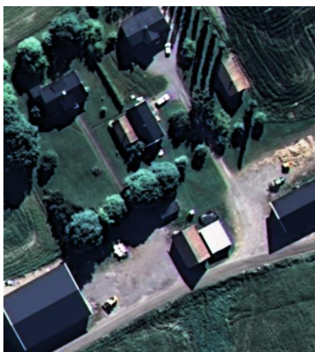
Exempel på panskarvt färgbild där bilderna ovan har kombinerats. Exemplet är fotograferat med Z/I DMC. Foto: Lantmäteriet 2005.
