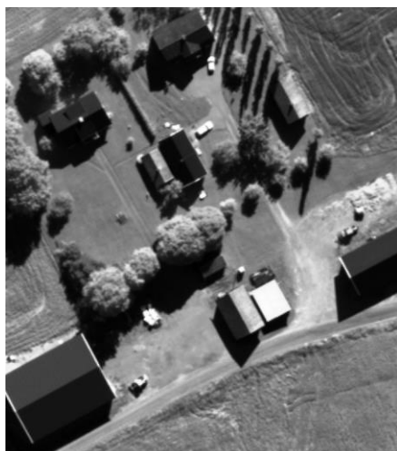
Den högupplösta pankromatiska bilden som används vid panskarvningen. Det är pixelstorleken i denna bild som brukar anges som måttet på bildens upplösning. Foto: Lantmäteriet 2005.
