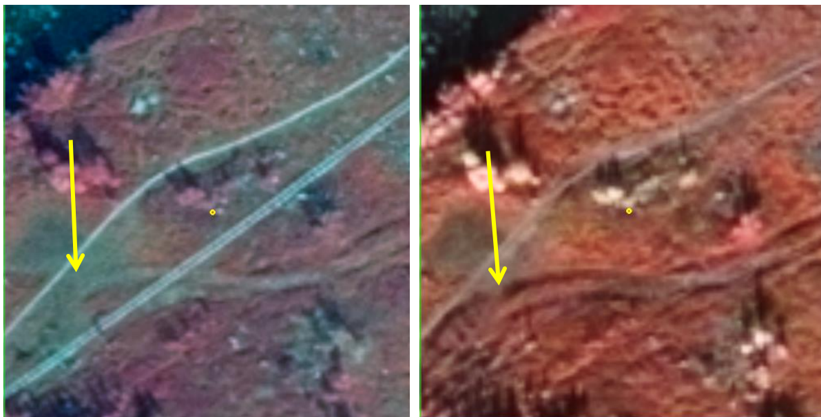
Figur 23. Bilden till vänster, från 2018 visar exempel på en förstärkning som innebär en rätning av leden men samtidigt på kort sikt ökat antalet spår i terrängen. Viss igenväxning av de gamla körspåren kan möjligen skönjas exempelvis vid pilen, jämför med bilden från 2008 till höger (även om marken troligen är fuktigare i den bilden).
