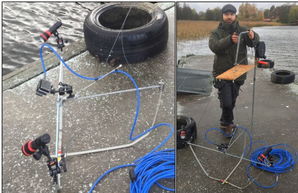
Figur 5. Vänster bild: dropkamera monterad med två ledlampor fastmonterad på en enkel stålram. Höger bild: en styranordning var kopplad till stålramen med tre linor. Den blå sladden kopplades till en iPad/iPhone som fungerade som fjärrkontroll och realtidsskärm (foto: Patrik Bohman, SLU).
