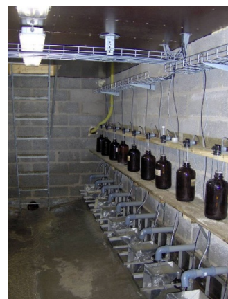
Lönnstorps försöksfält (foto Erik Rasmusson), vippkärl i mätstation vid Mellby (foto Gunnar Torstensson)
