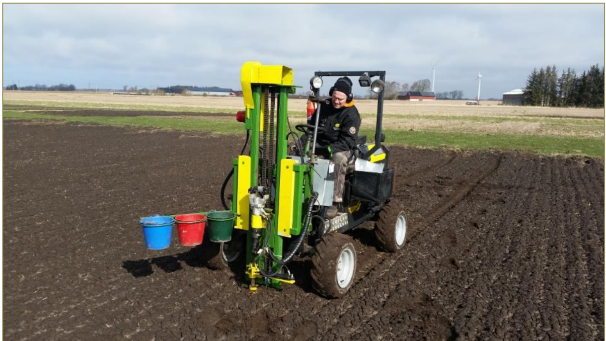
Vår i Mellby: Provtagning av mineralkväve på 30, 60 och 90 cm djup.
