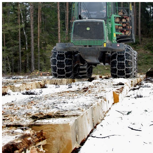
Figur 6. Tillverkade markskonare utlagda över en kort sträcka med mycket dålig bärighet. Foto: Alexander Östlund.
