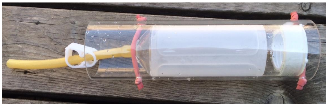
Bild 1. Sil i transportrör. Silen kan tas ut ur röret efter att gummistropen i den övre änden (till höger i bild) lyfts bort ur sitt spår. Förvara alltid silen i transportröret och med öppnad slangklämma.
