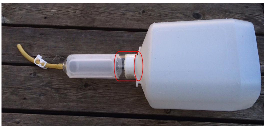
Bild 2. Sildukshållare på tratt. Håll endast i den rödmarkerade delen!
