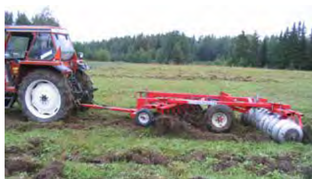
Bild 14. Ett tallriksredskap skär av ogräsens rötter och utlöpare. Kombinerat med plöjning kan det ge en bra ogräseffekt. (foto: Per-Erik Nemby)
