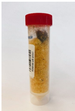
Figur 3. Silicans uppgift är att konservera provet genom att torka ut det. Silican innehåller en färgindikator där orange färg visar att den är funktionell och redo ta upp fukt. Bilden visar lagom mängd insamlad spillning.
