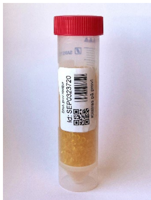
Figur 1. Streckkodsetiketten är korrekt placerad i rörets längdriktning.
