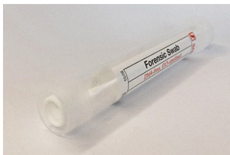
Figur 7. Provtagningssticka med tops används vid provtagning av saliv på bytesdjur, vid provtagning i munhålan på döda rovdjur samt ibland vid insamling av vargurin från snöfria substrat. Behållaren har ett DNA-tätt luftfilter i botten så att provet kan torka.
