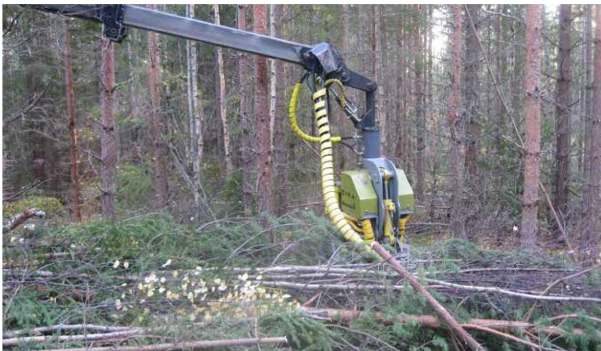
**Изображение 8.** При заготовке тонкомерной древесины харвестером применяются три вида срезающих устройств. Фото: Мария Иварссон Видэ
