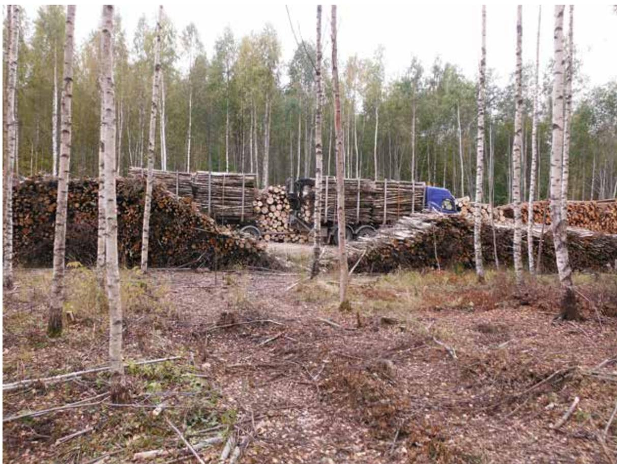
**Изображение 17.** В зависимости от того, насколько качественно удалены сучья, лесоматериал вполне можно перевозить на обычных лесовозах. Биомасса, полученная в результате лесоводственного ухода в березовом древостое, будет отправлена на завод по производству гранул в г. Екабпилс, Латвия. Фото: Андис Лаздиньш
