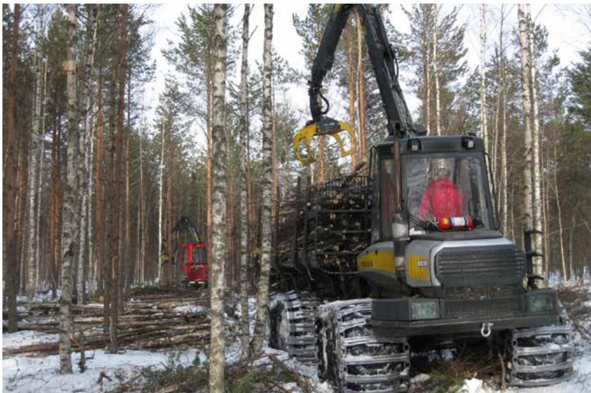
**Изображение 12.** Разработка лесосеки традиционной системой машин «харвестер – форвардер». Харвестер валит деревья и раскряжевывает стволы, форвардер трелюет их на придорожный склад. Фото: Юха Лайтила
