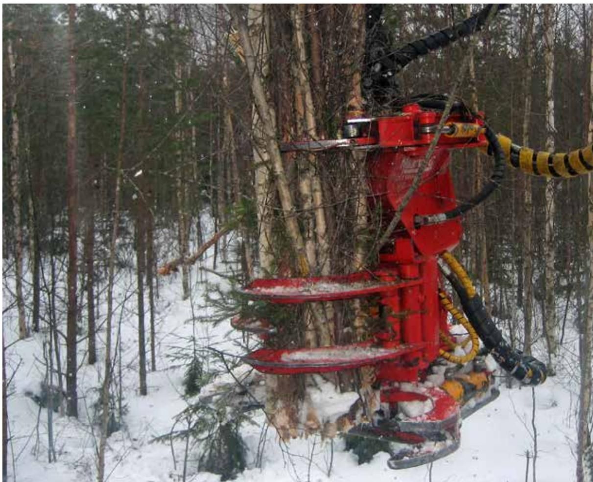
**Изображение 9.** Эффективные многозахватные агрегаты позволяют оператору харвестера накапливать несколько тонкомерных стволов для их одновременной обработки. Фото: Мария Иварссон Видэ
