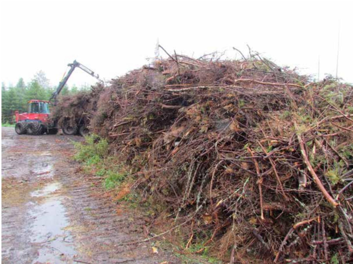
**Изображение 20.** Основная часть древесной щепы производится на погрузочных площадках – здесь происходит разгрузка и штабелирование порубочных остатков.
