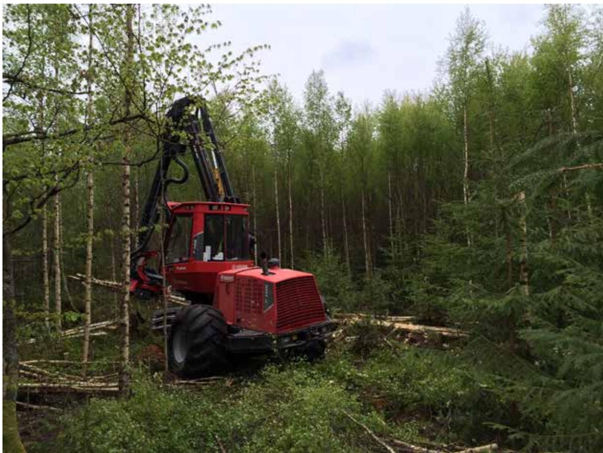
**Изображение 13.** В маломерных насаждениях основной расход рабочего времени харвестера приходится на перемещения манипулятора. Заготовка березового тонкомера в еловом молодняке. Фото: Орьян Грэнлунд
