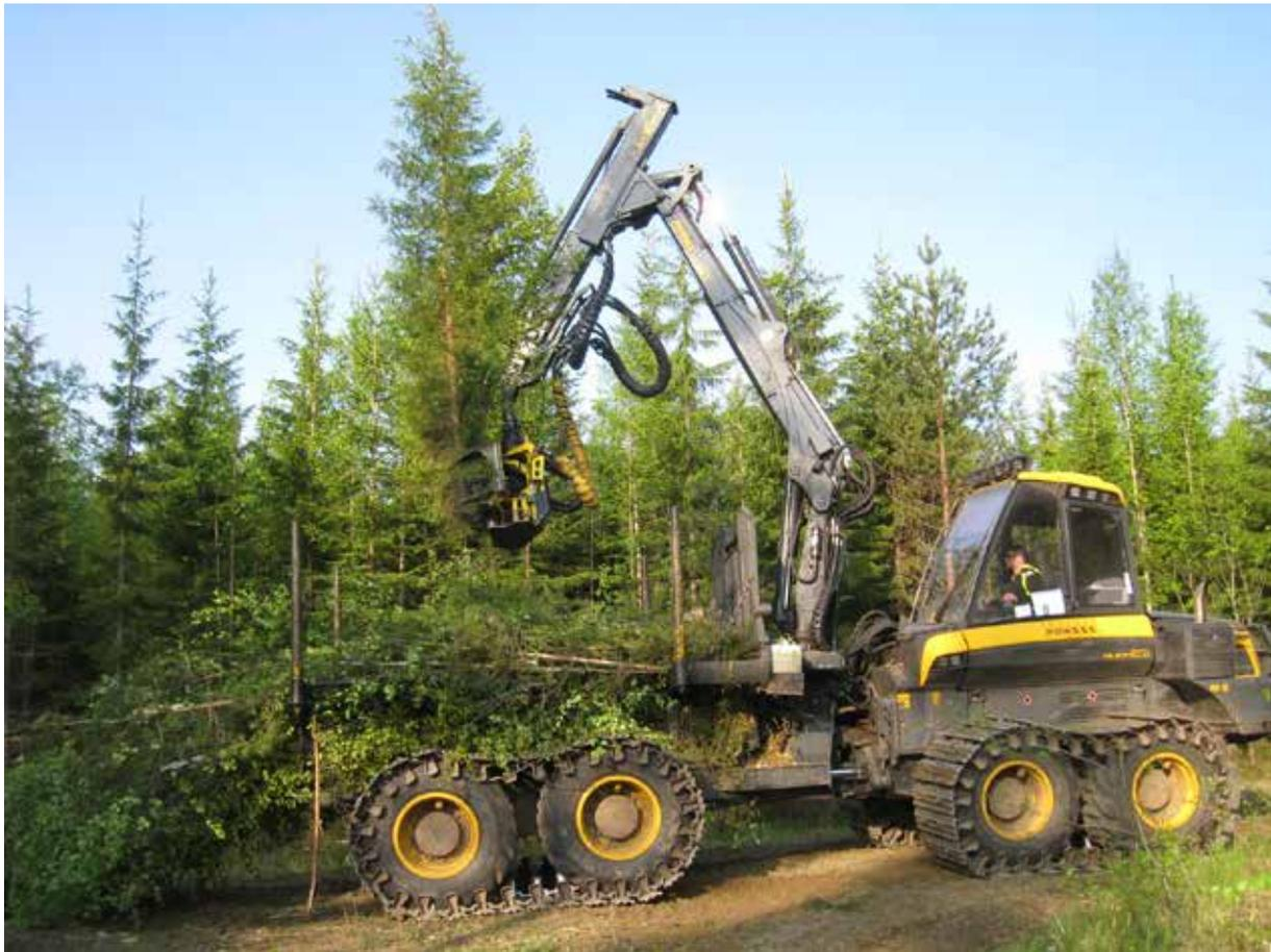
**Изображение 11.** Харвардер отличается эффективностью в условиях трелёвки на короткие расстояния и при заготовке тонкомерной древесины. Фото: Юха Лайтила
