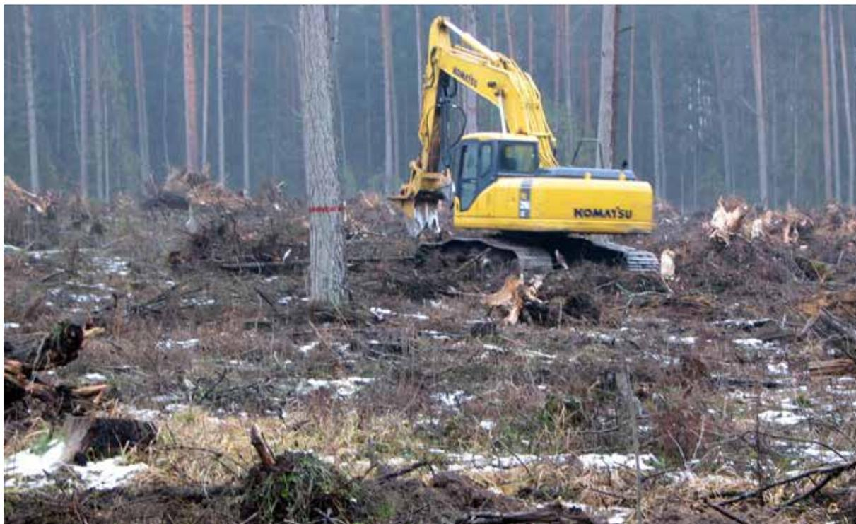
**Изображение 38.** Пни извлекают из почвы, раскалывают и собирают в кучи с помощью экскаваторов, оснащенных специальным устройством для выполнения данных операций. Одна из первых испытательных операций по корчевке пней после восстановительной рубки елового древостоя в Латвии. Фото: Валентинс Лазданс
