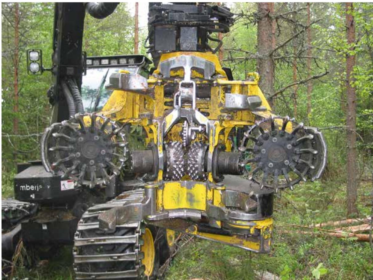
**Изображение 14.** Возможность эффективно перестраиваться с заготовки балансов на заготовку топливной древесины с помощью захватно-срезающего устройства харвестера с функцией накопления деревьев, оснащенного подающими вальцами. Фото: Юха Лайтила
