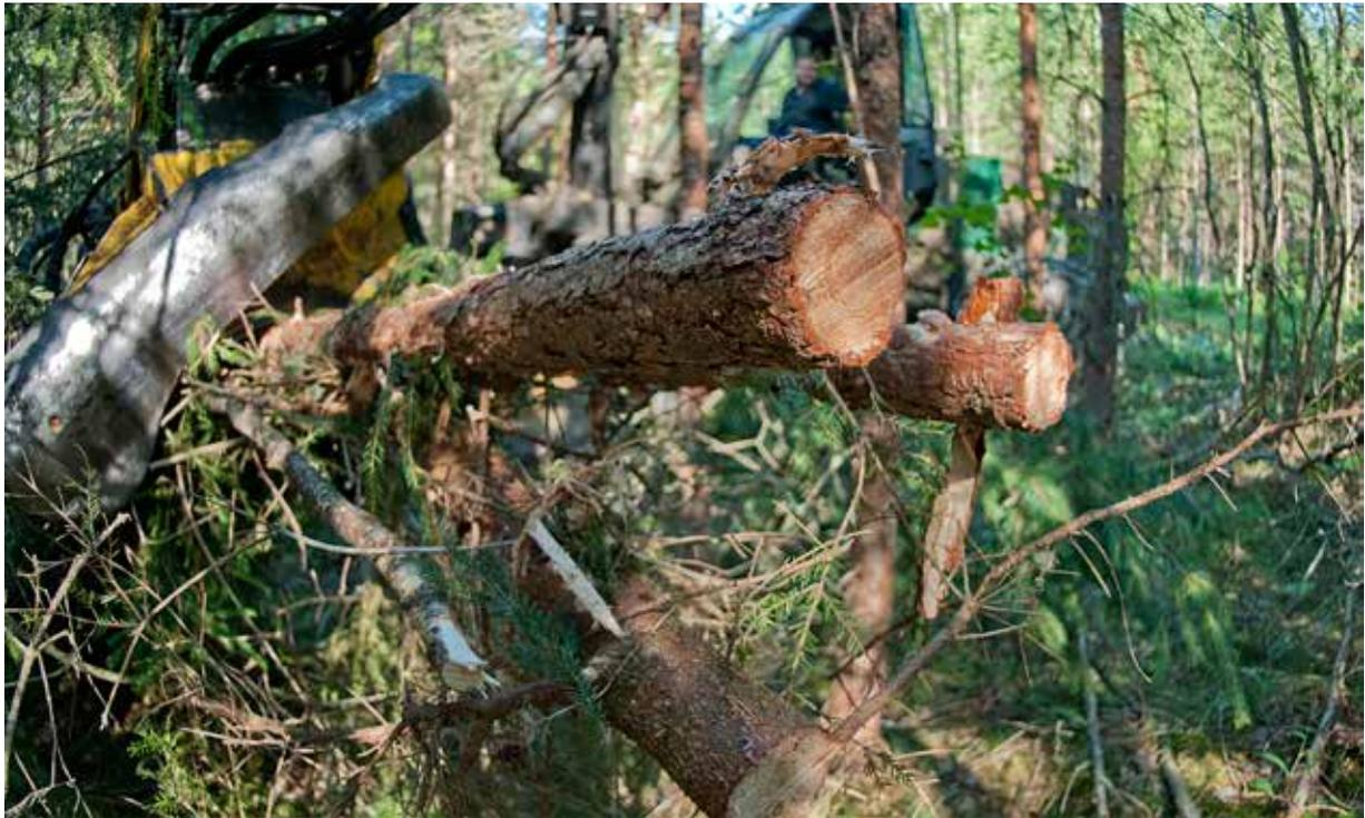
**Изображение 6.** Многофункциональная харвестерная головка оснащена функцией захвата нескольких стволов одновременно. Фото: Эрик Виклунд
