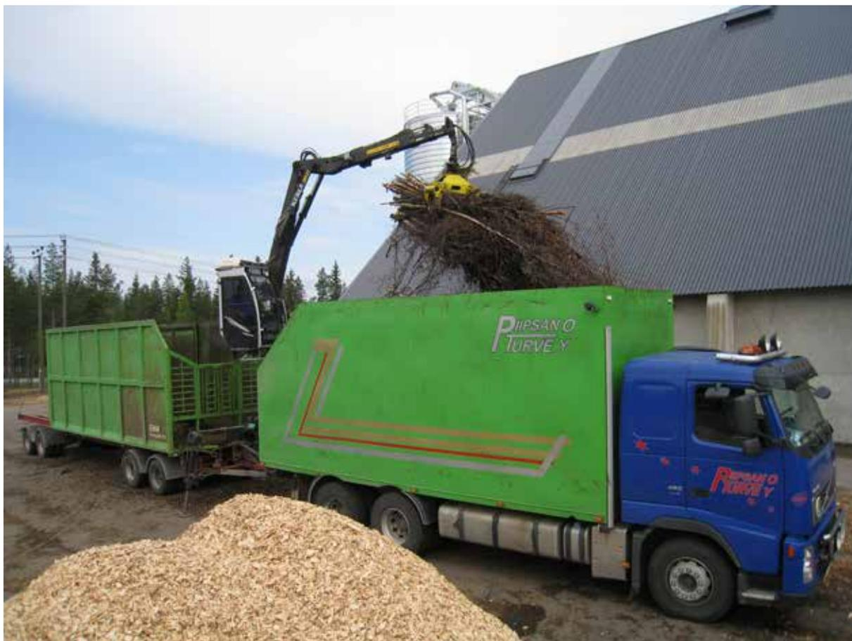
**Изображение 18.** Топливная древесина с необрезанными сучьями или порубочные остатки россыпью могут транспортироваться на терминал или конечным потребителям на платформах для перевозки биомассы с крытыми бортами. Фото: Юха Лайтила
