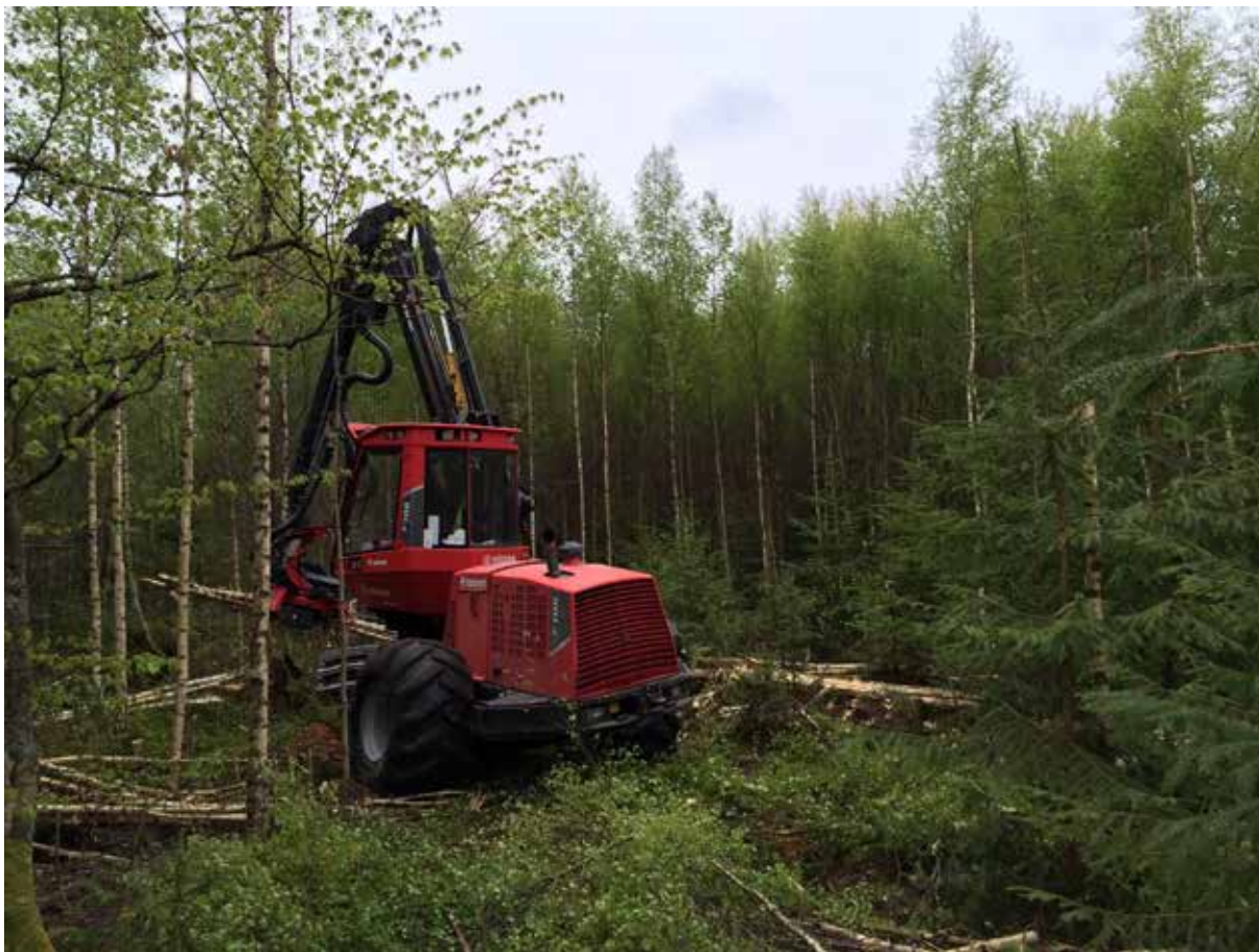
Pilt 13. Langetustraktoril kulub väikeste puudega puistutes palju aega kraana tööle. Kased eemaldatakse, kuused jäetakse alles. (Pilt: Örjan Grönlund)
