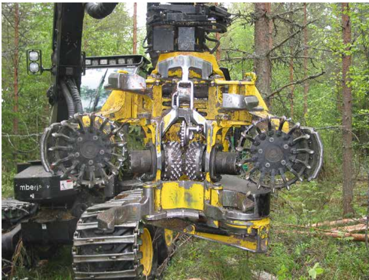
Pilt 14. Etteveoratastega akumulueeruva raiepeaga on võimalik kiiresti lülitada paberipuidu kogumiselt ümber metsakütuse kogumisele. (Foto autor: Juha Laitila)
