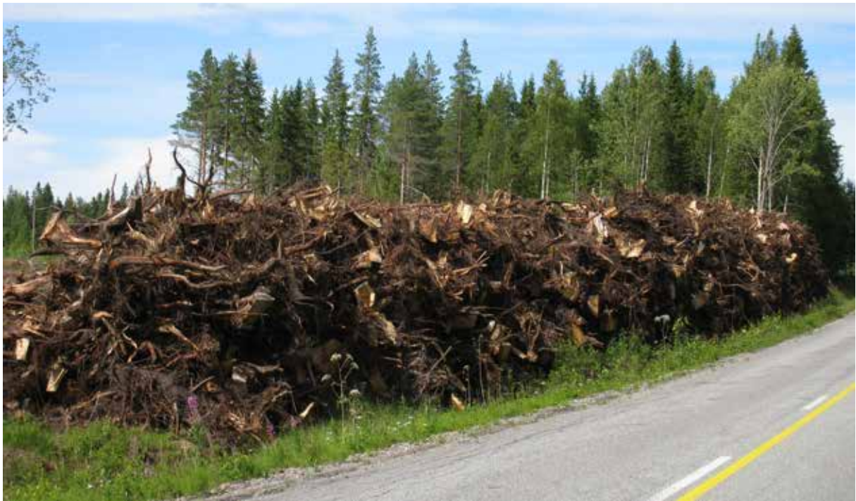
Pilt 41. Suvehooajal jäetakse lõhutud kändud paariks nädalaks kuivatamiseks ja puhastamiseks metsalangile, seejärel viiakse need teeäärsetele laoplatsidele. (Foto autor: Juha Laitila)
