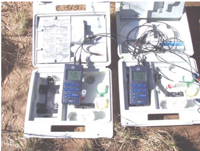
Vid rätt utförd pH-mätning och bra instrument visar båda samma pH! Foto: Fredrik Nilsson.
