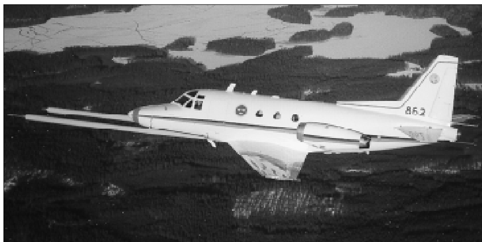
FIGUR 1. CARABAS-II-sensorn monterad på ett av försvarets försöksflygplan. De två bommarna framför flygplanet innehåller vardera en fem meter lång radarantenn. Foto: FMV:Prov.
