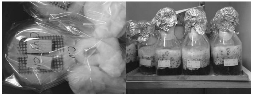
Figur 4. Laboratorieförsök för att bedöma olika impregneringsmedels rötbeständighet. EN 113-test till vänster och soil jar-test till höger.
