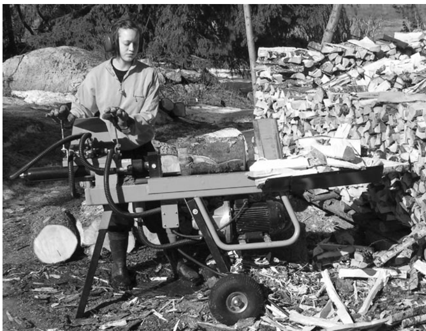
Figur 3. Säkerhetsföreskrifterna föreskriver tvåhandskommando och ensamarbete, precis som på bilden, men trots detta är hydraulklyvsolyckor vanliga. (Foto Gustaf Egnell).
