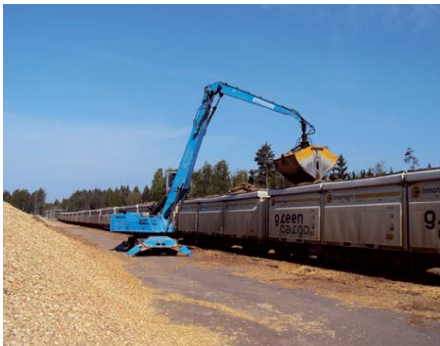
Figur 4. Längre transporter av biomassa bör ske med tåg eller båt för att minska energianvändningen. Foto Magnus Johansson.
