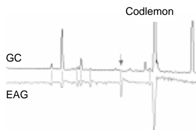
FIGUR 1. GC-EAG-metoden. En avklippt insektsantenn placeras mellan två elektroder. Gaskromatografiskt (GC) separeras de olika ämnena, som finns i ett extrakt av honans feromonkörtel. Ämnena träffar antennen ett efter ett. En biologiskt aktiv komponent orsakar en svag elektrisk spänningsförändring i antennen. Detta registreras som ett utslag på EAG-kurvan (elektroantennogram).
