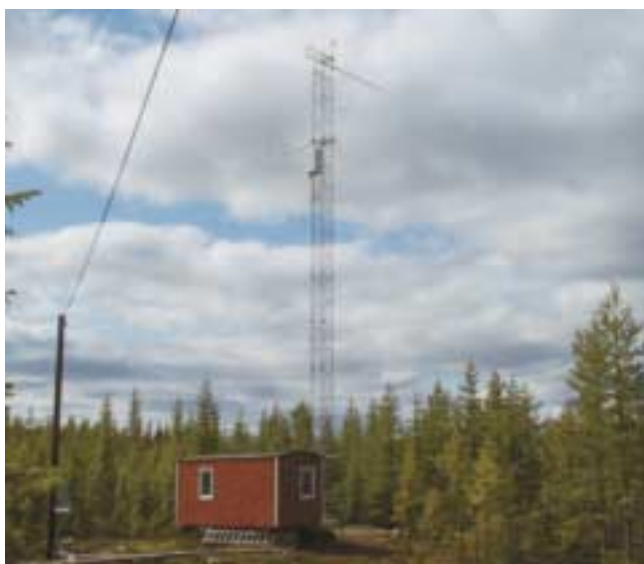
Mätningar av koldioxidflöden ovanför krontaken visar om skogen avger eller tar upp koldioxid. Mätutrustningen sitter monterad i en mast som sträcker sig ovanför trädkronorna.
