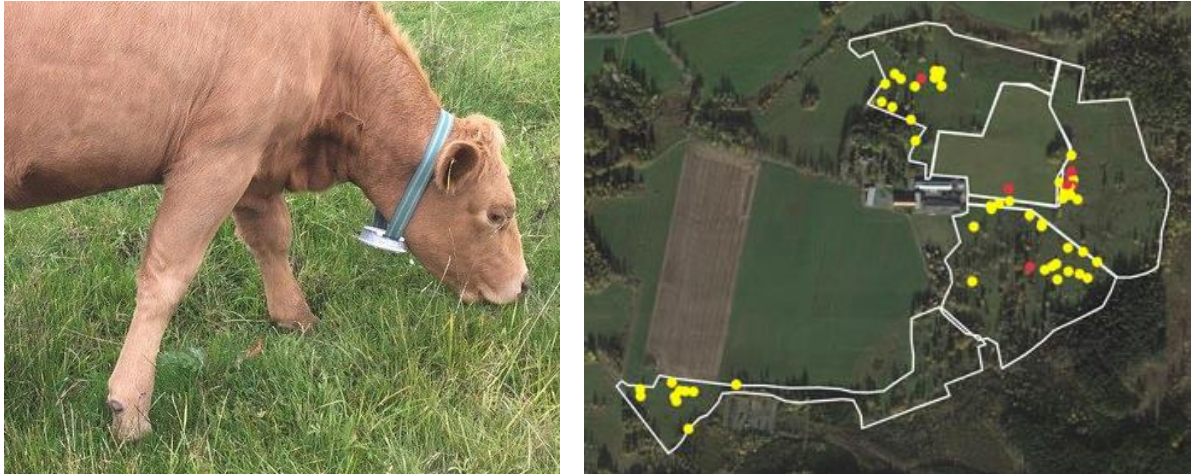
Figur 4. T.v.: Prototyp av halsbandsenheten Goati med GPS-mottagare, gyroskop samt accelerometer, T.h.: Digital karta för övervakning av djur i hagar. Källa: SmartAgri, SLU
