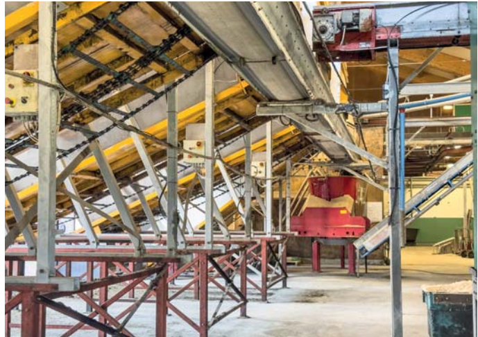
Avlastarbord, kraftfodersilor och övriga komponenter fyller mixern.
