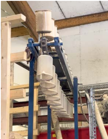
System med utbytbara koppar i olika storlekar gör det enkelt att tillsättakompletterande fodermedel, även i små mängder.
