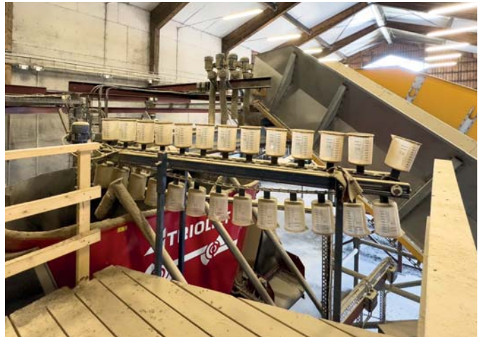
System med utbytbara koppar i olika storlekar gör det enkelt att tillsättakompletterande fodermedel, även i små mängder.
