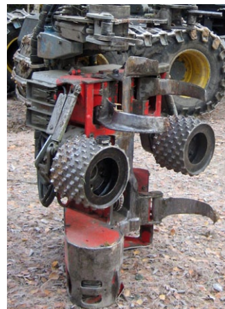
Skördaraggregat med sågsvärd och matarvalsar.
