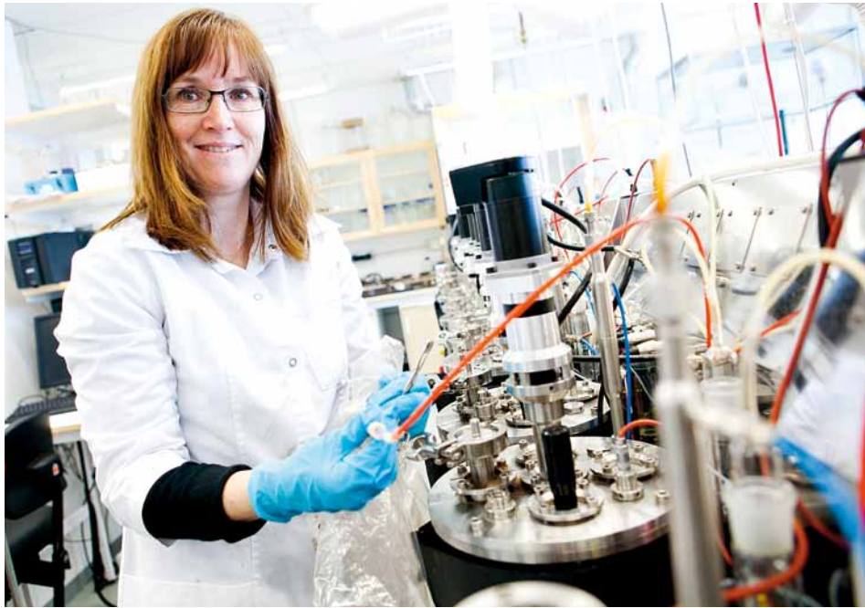
Anna Schnürer i biogaslabbet. Här matas mikroorganismer med matavfall. När avfallet bryts ner bildas biogas. Bland annat vill man ta reda på hur mycket systemet kan gödas utan att det kollapsar. 🐣
