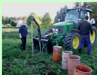
Fig 2 (↑) och 3 (↓). I mezonetrorna märks växterna via bladen, och inmärkningarna kan följas ut i jorden. Nätet fångar upp nedfallna blad. Vid slutet av växtsäsongen lyfts de 85 cm djupa mezonetrorna upp och rötter och jord analyseras.
