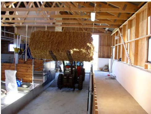
Figur 22. Ekologisk slaktgrisproduktion. Halmen hanteras i form av storbalar som transporteras in i stallet med traktorlastare.
