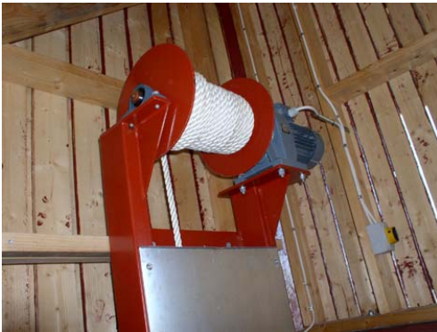
Figur 25. Ekologisk slaktgrisproduktion. Gödseln i kulverten skrapas till en pumpbrunn utanför stallet med en lindriven slädskrapa.
