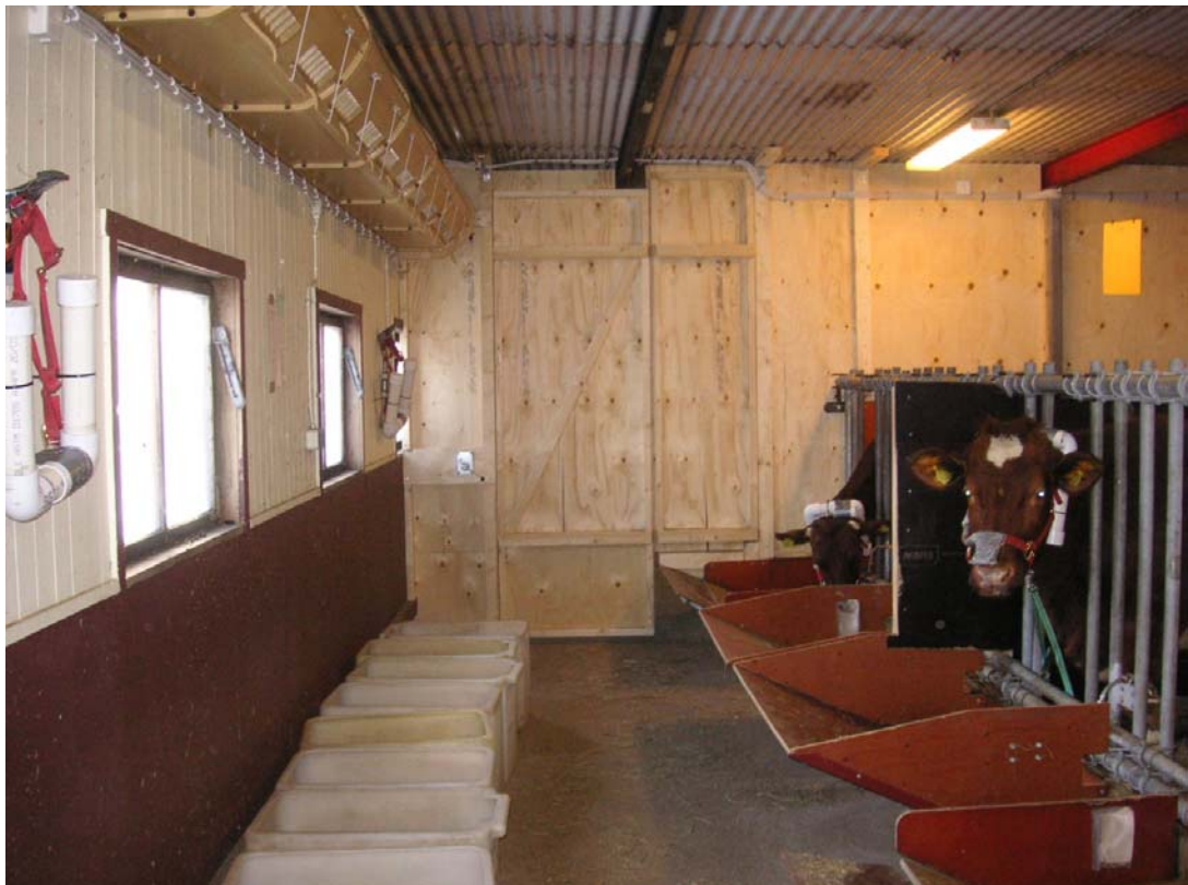
Figur 3. "Metanstuga" med väggar. Uppe till vänster syns ett extra ventilationsrör som monterades in. På väggen till vänster hänger en enhet som mäter stalluftens metaninnehåll.
