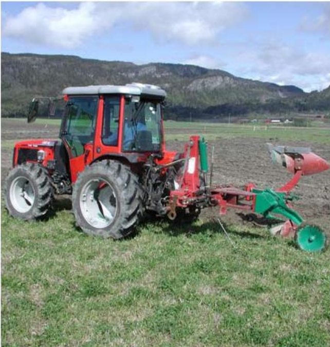
Traktorene på Kvithamar. T.v. en Carraro TRG 9400, 2480 kg. T.h. en Valmet 6100 Mezzo, 5080 kg. Bruk av ønskjærsplog gav full hjuldekking hvert år.
