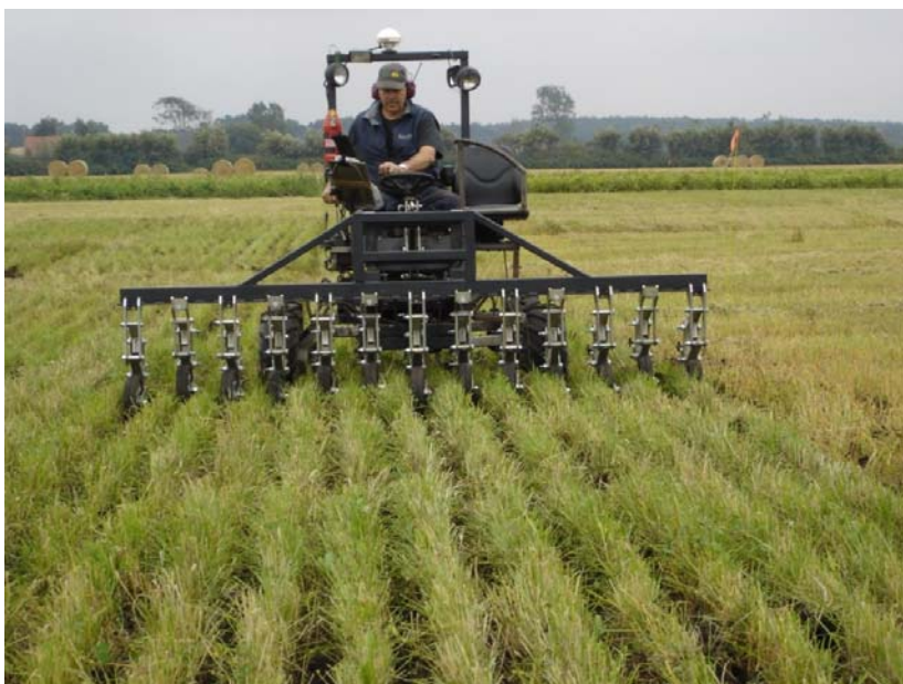
Figur 1. Led E i försöket vid Lilla Böslid vid skörd 2011. Insådd mellangröda förväntas konkurrera med ogräset i raden och minska risken för kväveläckage. Brett radavstånd gör det möjligt att använda gåsfotskär för att bekämpa rot- och frögräs mellan raderna.
