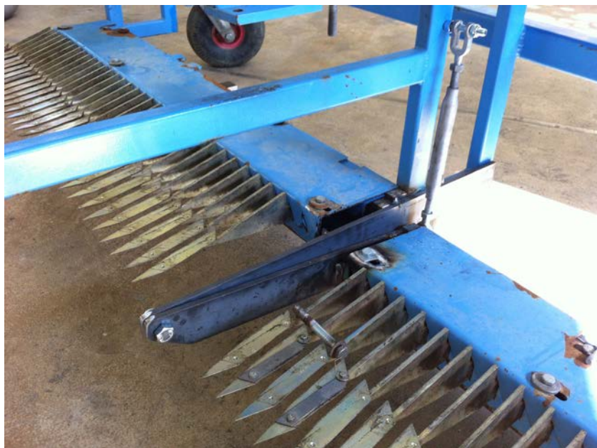
Figur 11. Ombyggd ogräskärarmodul med delad knivbalk. Foto: Jonas Engström, JTI.
