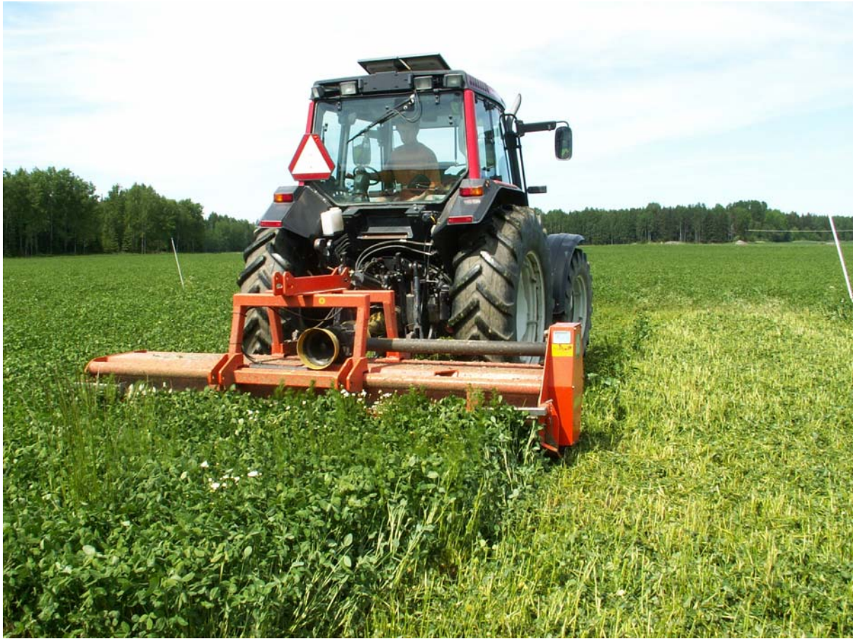
Figur 2. Hård putsning 40 cm beståndshöjd med "frontmonterad" putsare.
