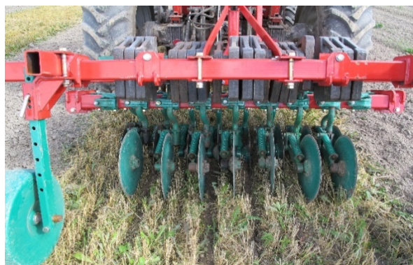
Figur 1. Vertikal rot/rhizom-skärare ("Oscar Prototyp" tillverkad av Kverneland ASA).
