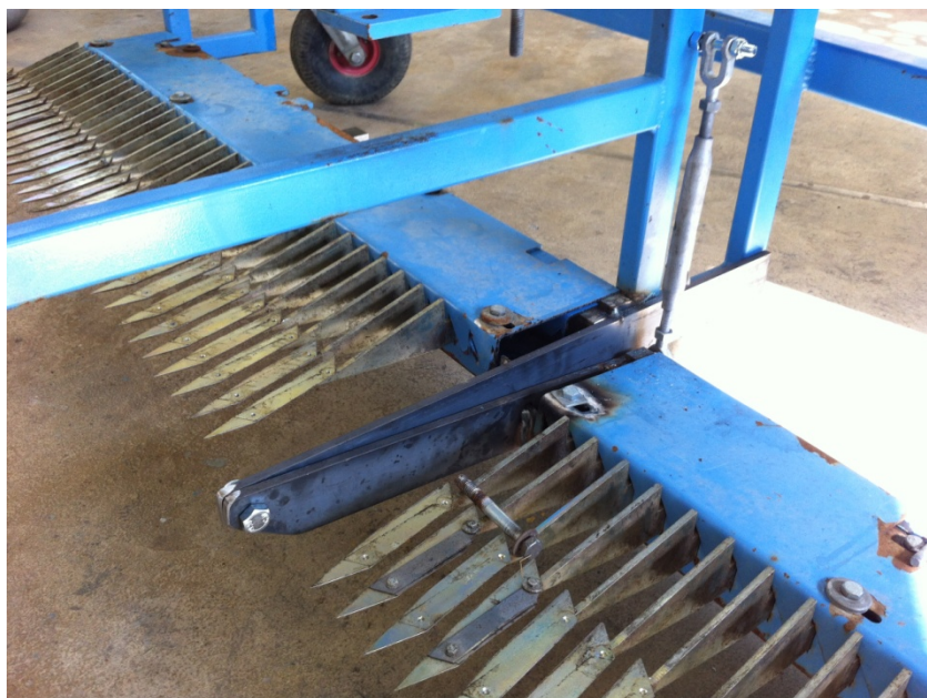
Figur 5. Ombyggd ogräskärarmodul med delad knivbalk. Foto: Jonas Engström, RISE
