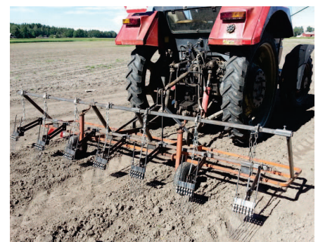
Figur 6. Utrustning för selektiv harvning i morotsraden med ett "harvagggregat" per morotsrad. Foto: David Hansson.
