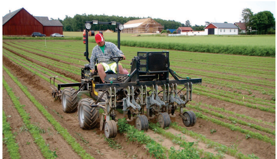
Figur 5. Utrustning för selektiv harvning i morotsraden. Radhackaren utrustades med ett "harvagggregat" per morotsrad, d.v.s. tre harvagggregat per bädd. Foto: David Hansson.
