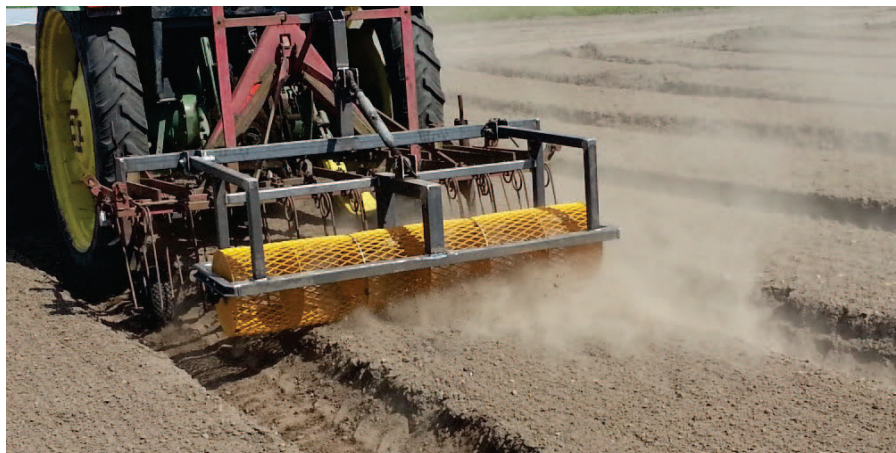
Figur 4. Utrustning för falska såbäddar på upphöjd bädd. Redskapet är en modifierad långfingerharv utrustad med en gallervält bak som "bärnulle" för djuphållning lätt återpackning. Foto: David Hansson.
