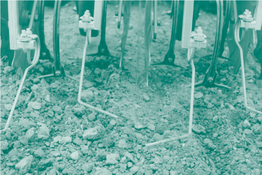
Med skrappinnarna kan ogräsen bearbetas i raden med liten påverkan på löken. Bilden visar skrappinnar som är ställda isär 6 cm för att kunna användas i ung frölök. Foto: Johan Ascard.
