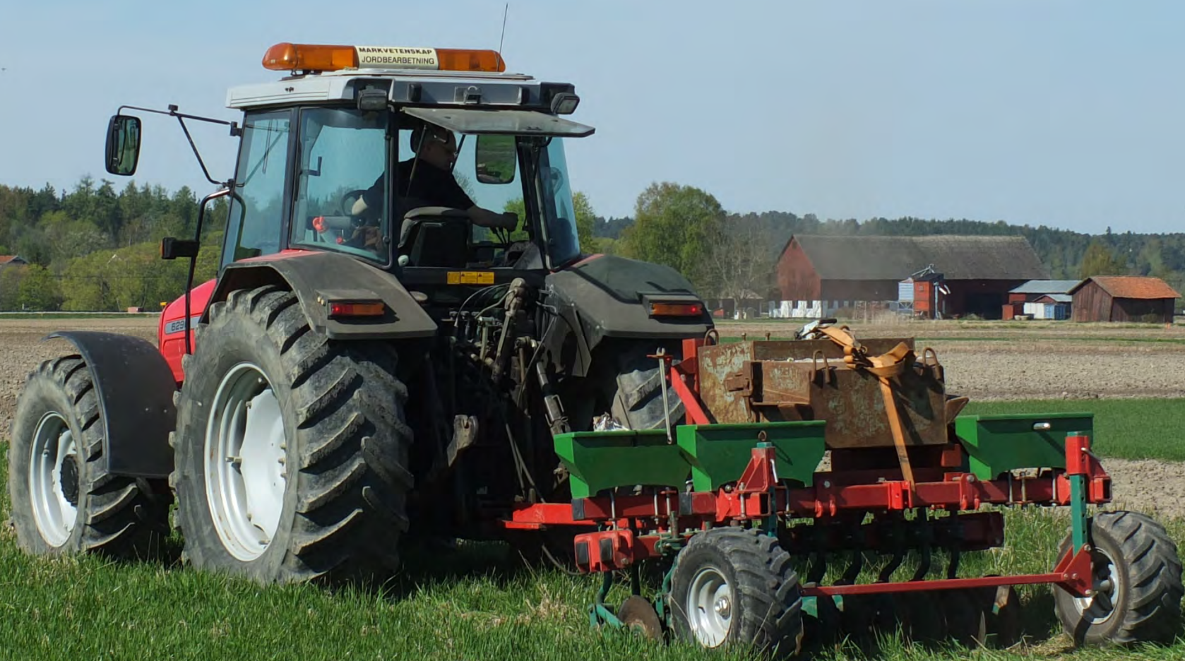
Foto: Marcos Lana. Vertikalskärning av vall på Säby utanför Uppsala våren 2018. Prototyp: Kverneland
