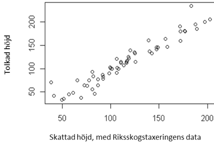
Figur 16 Flygbildstolkad höjd på utvärderingsprovytor, jämfört med skattad höjd där Riksskogstaxeringens provytor använts tillsammans för skattning med laserdata. Förhållandet är nära ett till ett.
