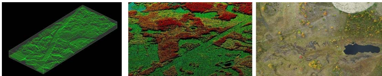
Figur 13. Från vänster till höger exempel på bildmatchning med två flygbilder sammanslagna för att skapa en 3-D-bild, punktmoln baserat på laserscannad data (båda underlag från NILS flygbildstolkning) och högupplöst låghöjdsfoto 24 (det runda området i fotots överkant är en gärda för renskiljning, Stekkenjokk Västerbotten).
