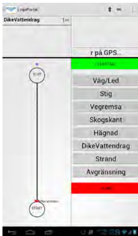
Figur 8.2. Linjeskärmen. I Skärmkomponent 1 (nedre) visas en grafisk representation av inventeringslinjen och registrerade linjeobjekt, samt menylistan med linjeobjektstyper. I skärmkomponent 2 (övre vänster) visas registrerade linjeobjekt. I skärmkomponent 3 (övre höger) visas aktuell GPS-kontakt och avstånd längs linjen (ej med i figuren).
