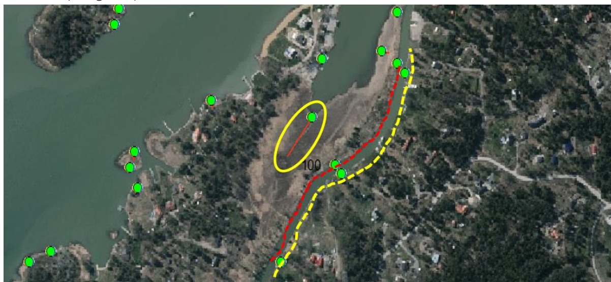
Figur 25: Exempel ovan visar stränder längs grävda kanaler, från Trosa (Ruta 100, inventeringsår 2019). Kanalen och strandlinjen hålls fri från vegetation (vass) genom mänsklig aktivitet gräva/muddra. Muddermassor lastas upp på stranden med den röda streckade linjen och klassas därför som strandtyp/markanvändning konstruerad. Punkter som faller på stranden längs den gula linjen kommer klassas enligt hur strandlinjen ser ut just vid punkten. Däremot klassas punkt och transekt inom den gula cirkeln som strandäng, eftersom denna inte är påverkad av muddringen.
