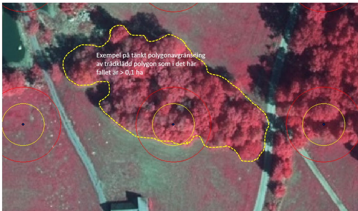
Figur 4. Bilden visar hur tolkaren föreställer sig polygoner under tolkningen. Den gula streckade linjen föreställer en trädgårdspolygon som bedöms av tolkaren. Polygonavgränsningen avgör när en polygon är stor nog att klassificeras och när den är för liten generaliseras den till omgivande polygon. Gräsmarken som även klassas här är också en polygon som är >0,1 ha.
