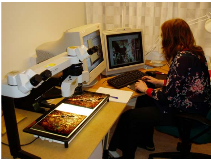
Figur 4. Bildtolkningsutrustning. Digital fotogrammetrisk arbetsstation och zoomstereoskop. Stereobetraktning sker på den högra bildskärmen med hjälp av ett polarisationsfilter och speciella polariserande glasögon. Kartan presenteras på den vänstra bildskärmen. Med hjälp av en speciell datamus kan man förflytta sig i stereomodellen i tre dimensioner och även utföra höjdmätningar samt kartera (digitalisera) polygongränser och andra objekt. Vid behov kan diapositiv studeras i zoomstereoskopet (till vänster i bilden).
